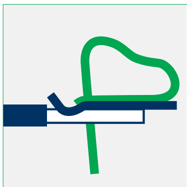
Système de connexion à ressort -principe de connexion à ressort-
