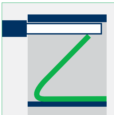
Système de connexion à insertion directe -principe à ressort à insertion directe-
